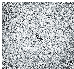
Ci-haut : Bris spontané d'un verre trempé thermiquement.
